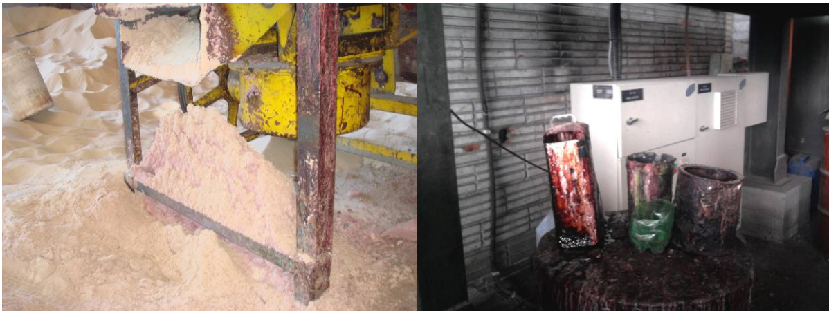
Figura 5: Perdas de areia fenólica, resina e catalisador.
