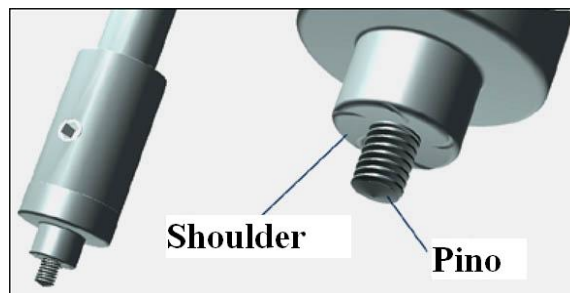
Figura 2. Ilustração da ferramenta usada no processo FSW.
