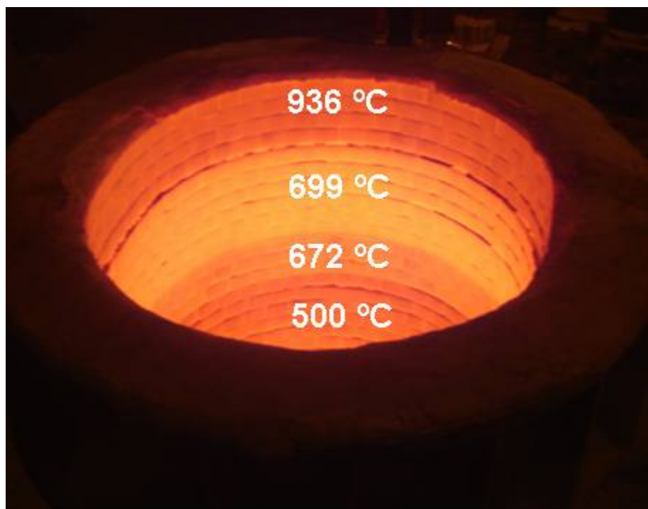
Figura 2. Perfil térmico de uma panela no final de seu aquecimento para entrar no ciclo e receber vazamento do aço.
