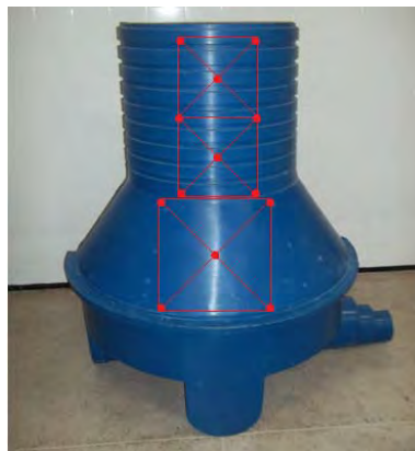
Figura 6. Esquema de varredura pra ensaio de EA no PV.
