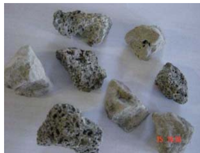
Figura 2. Foto da escória bruta de alto-forno.
