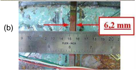
Figura 5. Abertura e tensões nos tubos após o seccionamento pelo centro do cordão de solda: (a) Helicoidal; (b) Longitudinal.
