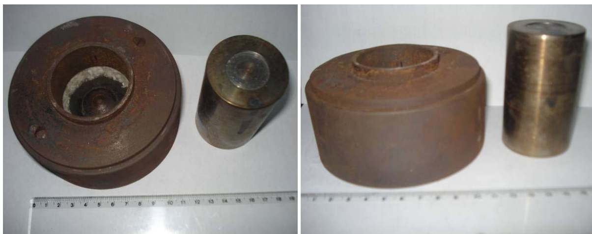
Figura 8. Dispositivo em aço ferramenta AISI H13 para conformação de alumínio.
