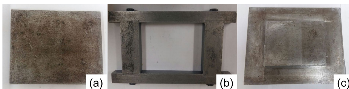
Figura 2. Conjunto que compõe a matriz metálica (a) chapa interna inferior, (b) camisa, e (c) punção superior.
