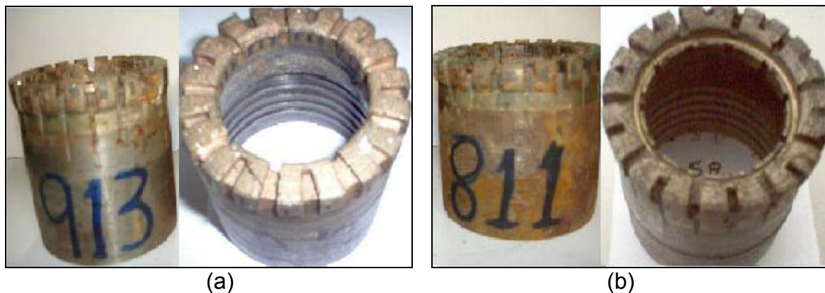
Figura 7. Aspecto físico de uma broca; (a) S9 e (b) outra S8, ambas, usadas em perfurações para sondagem geológica.
