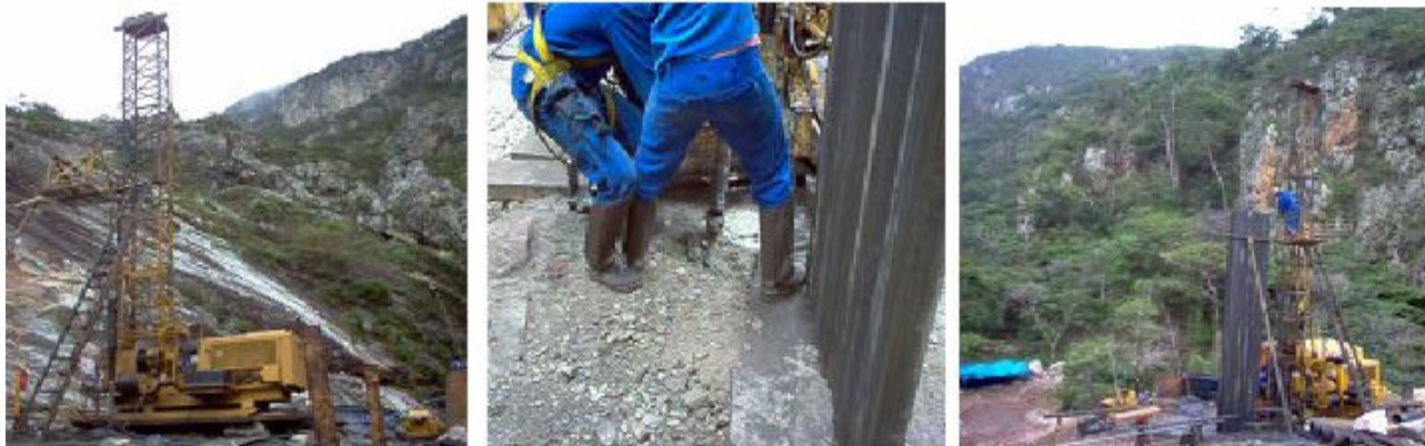
Figura 2. (a) Sonda rotativa para perfuração em sondagem geológica. (b) Início de operação de perfuração com uma coroa produzida no estudo. (c) Vista geral de uma praça para sondagem com equipamentos e ferramentas.
