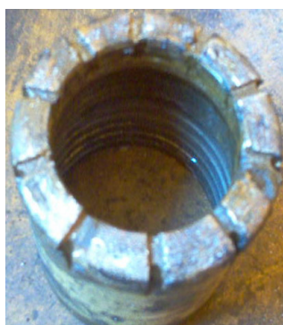
Figura 7. Aspecto físico de uma broca S8 usada em perfurações para sondagem geológica.
