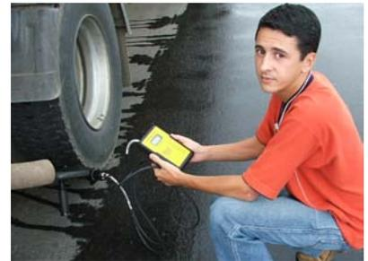
Figura 9. Opacímetro (Instrumento de Medição de Fumaça Negra)
