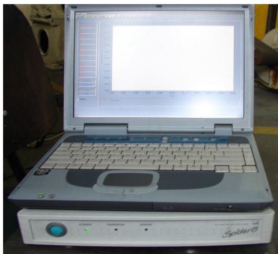
Figura 10: Sistema de aquisição de dados, Spider 8 com o software Catman Express 3.1.
