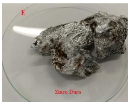
Figura 4. Resíduos da galvanização a fogo. E – Zinco Duro.
