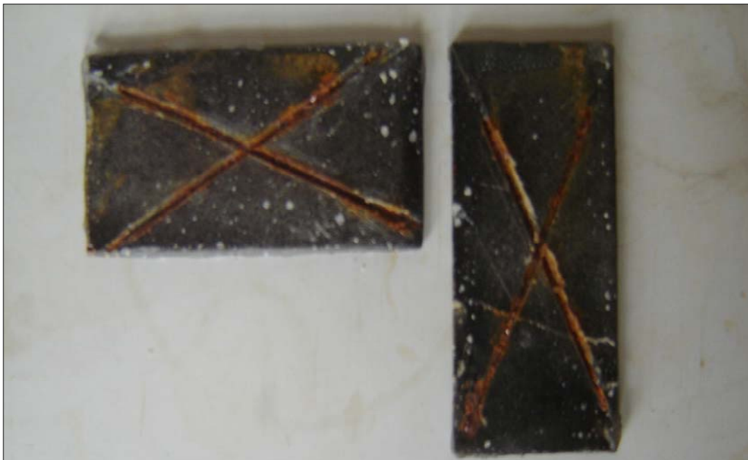
Figura 2: Amostra recoberta com PET e 1,0% de flocos de vidro
