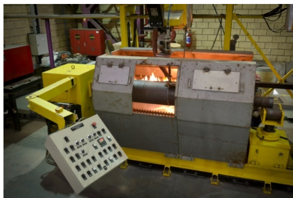
Figura 5. Vista geral da Máquina de Revestimento de Rolos (MRR), na unidade da PTBRA, localizada em Santa Cruz – RJ, durante soldagem dos revestimentos na Barra Teste.
