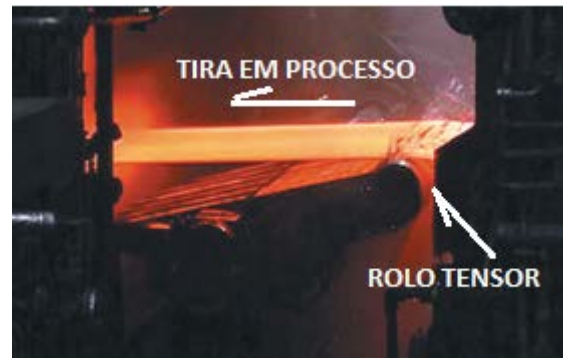
Figura 3. Tira de aço processada no sistema LTQ, evidenciando o Rolo Tensor entre as cadeiras do laminador.
