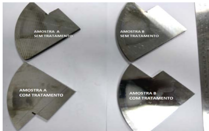
Figura 8. Corpos de prova retirados para os ensaios, dos Revestimentos A e B, respectivamente, CP A e CP B, antes e após tratamento térmico.
