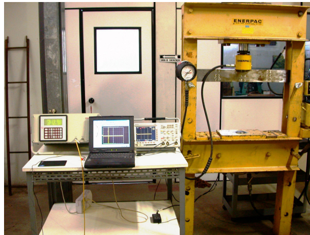
Figura 3. Fotografia do sistema ultra-sônico e da barra sendo submetida à flexão
