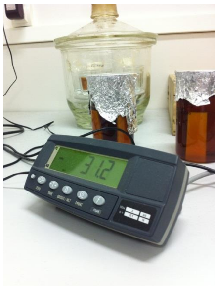
Figura 5. Visor de força (iniciando o achatamento)
