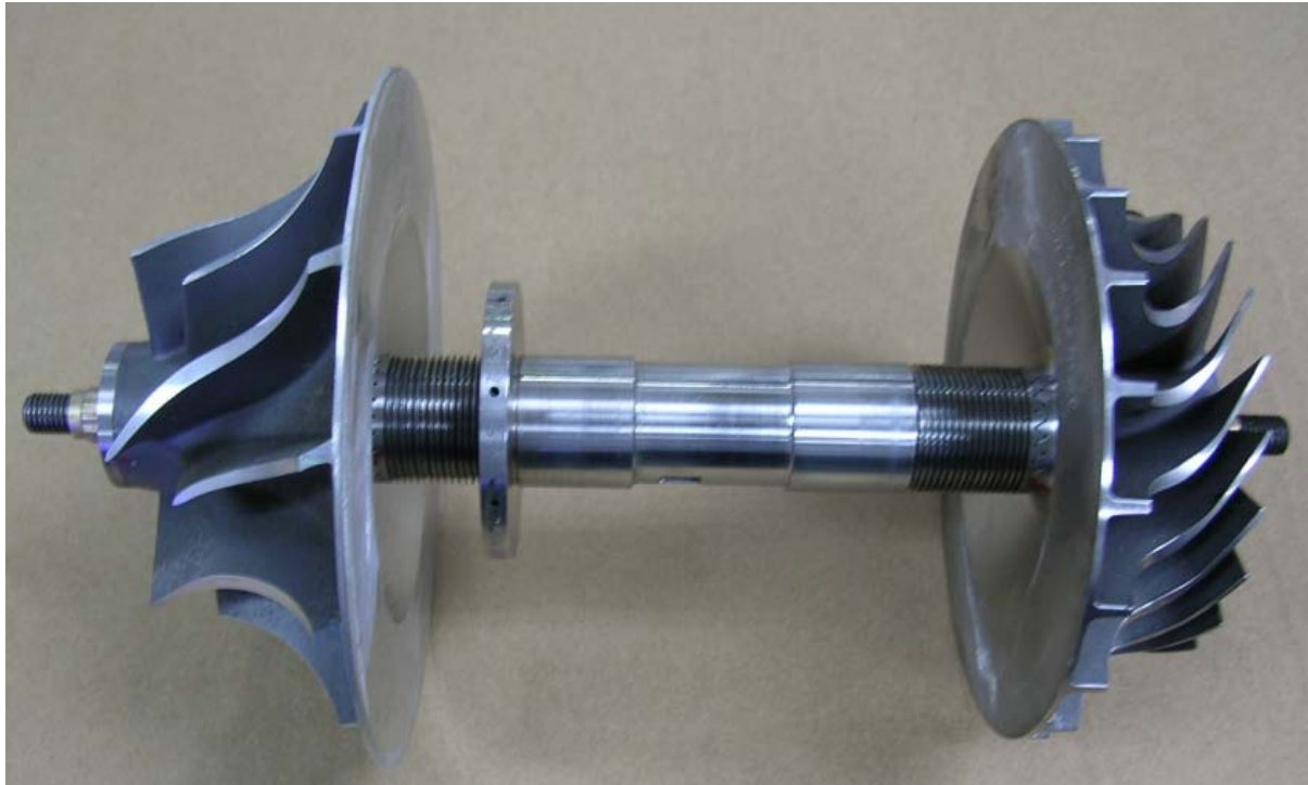
Figura 3 Foto do Conjunto Rotativo da Turbina Modelo LDBC/W-701
