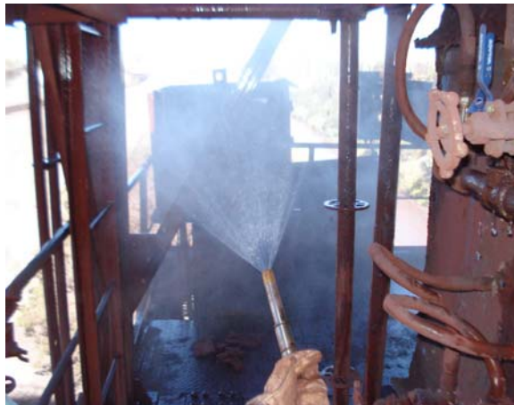
Figura 2. Teste de desempenho do bico spray .
