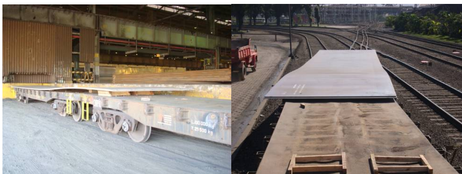
Figura 9 – Utilização de dois vagões na transferência interna de chapas - Suape
