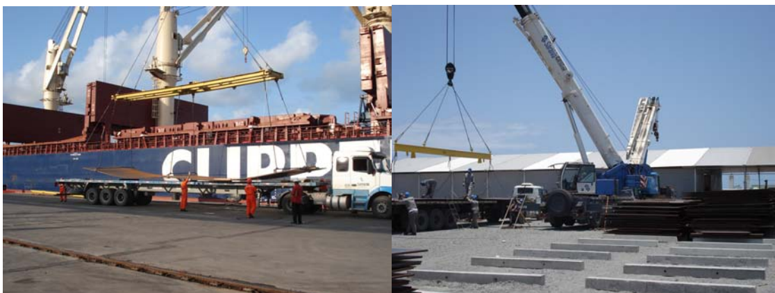
Figura 12 – Descarga do navio em Suape em carretas extensivas e recebimento no EAS
