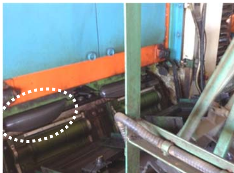
Figura 1. Rebarba da telha (em detalhe)
