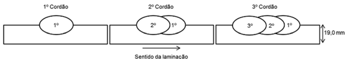
Figura 1. Representação esquemática do corte transversal da chapa.
