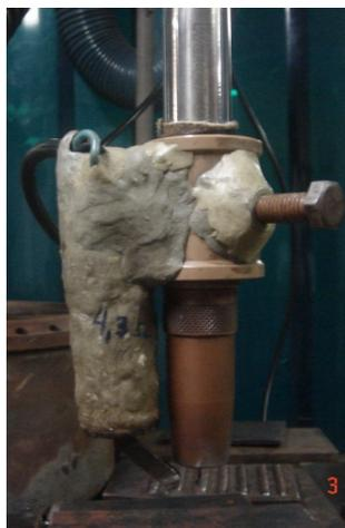
**Figura 2:** Foto da tocha de soldagem acoplada a bobina de geração de campo.
