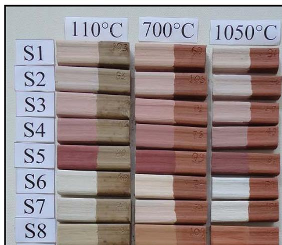
**Figura 6.** Corpos de prova pintados com engobes, que foram passados nas peneiras # 200, antes (110°C) e após a queima (700°C-1.050°C).
