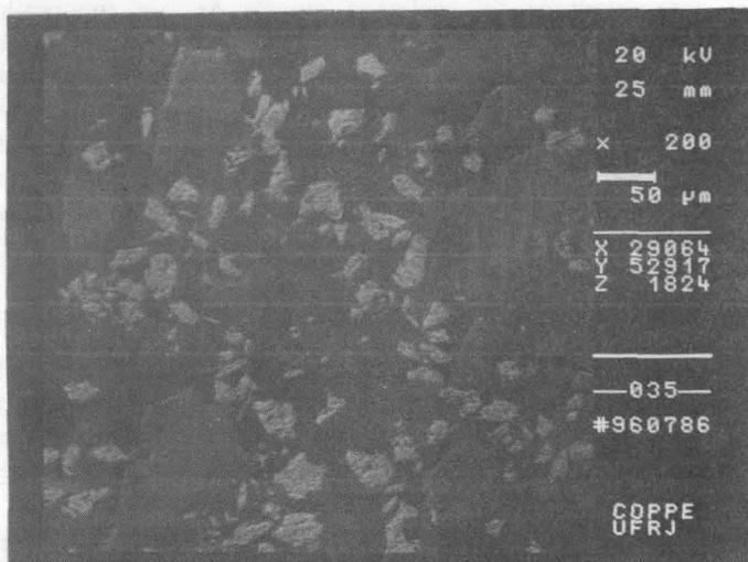
**Figura 2 - Fotomicrografia da amostra do rejeito de flotação do minério da mina de Pico. Amostra com baixa sílica (Aumento 200X).**
