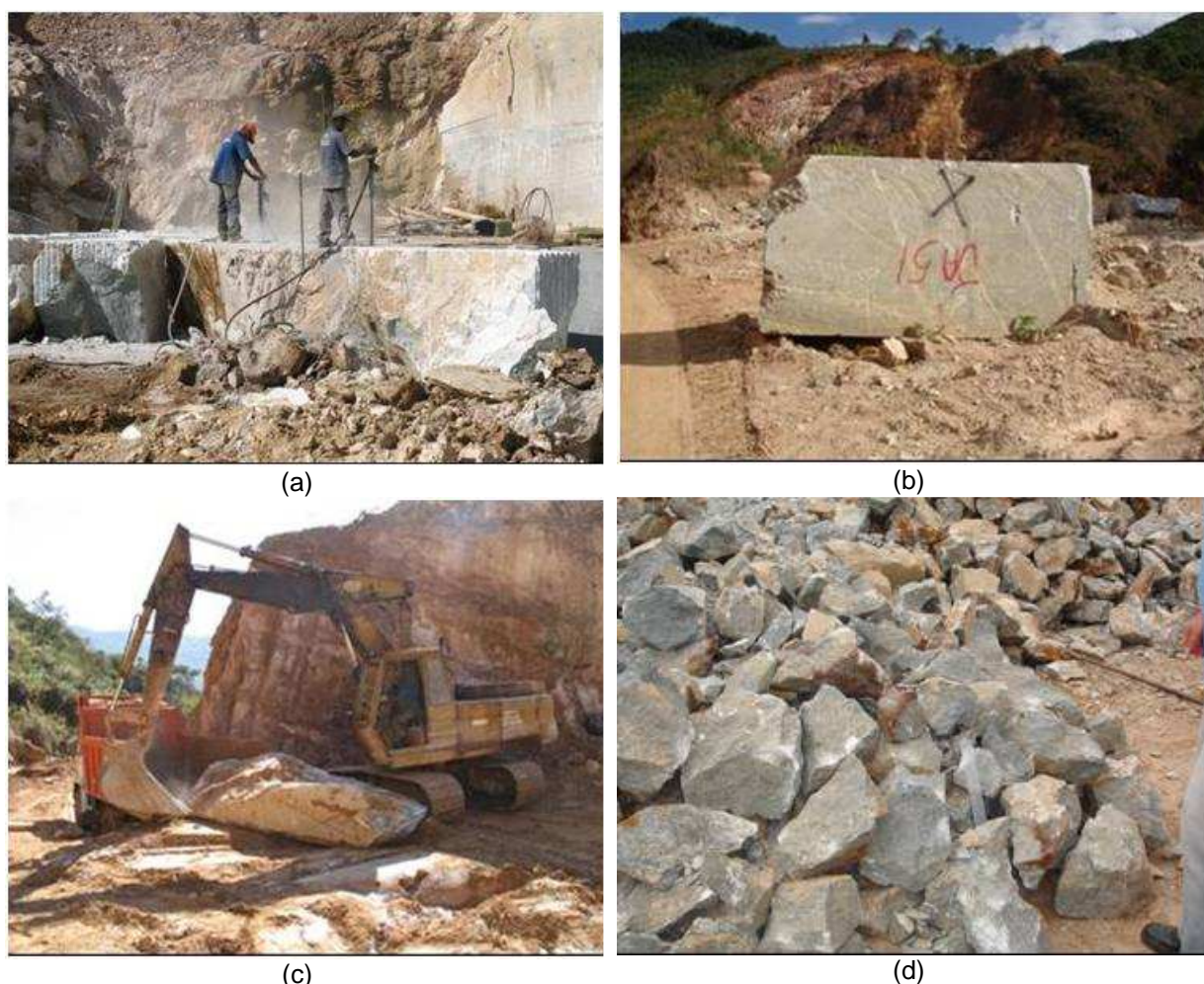
Figura 1 – Operações de perfuração para desmonte (a), bloco para exportação (b), carregamento do caminhão para transporte do bloco desmontado (c) e pontas, que são utilizadas pelos artesãos (d).
