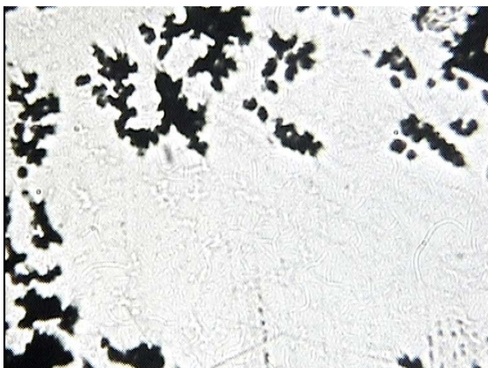
Figura 2 (b) – Aspecto micrográfico da liga FIT- FLEX. Ataque: Persulfato de amônia, aumento: 500X.
