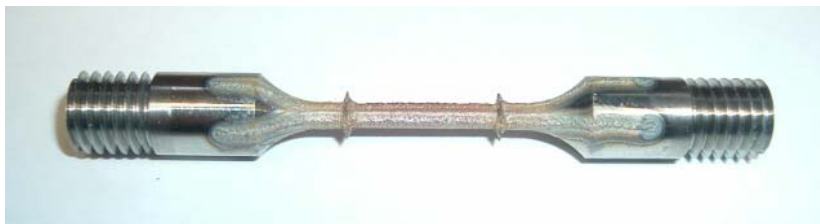
Figura 3. Corpo-de-prova nitretado por laser pulsado Nd:YAG.
