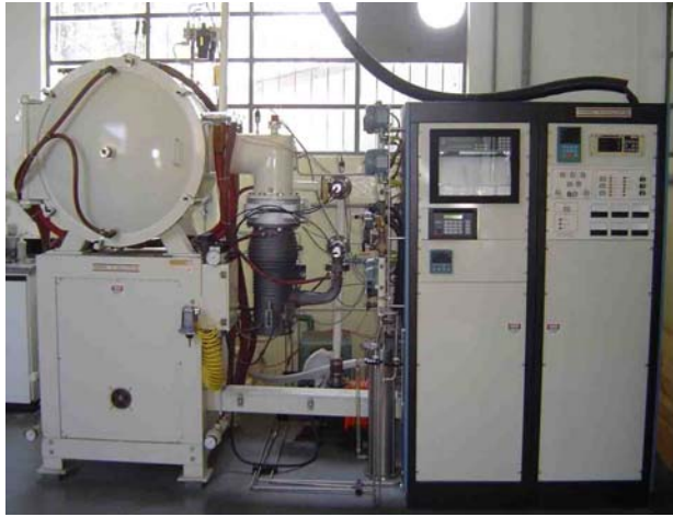
Figura 1. Forno a vácuo da Thermal Technology Inc. Metalmaster 121212W utilizado.
