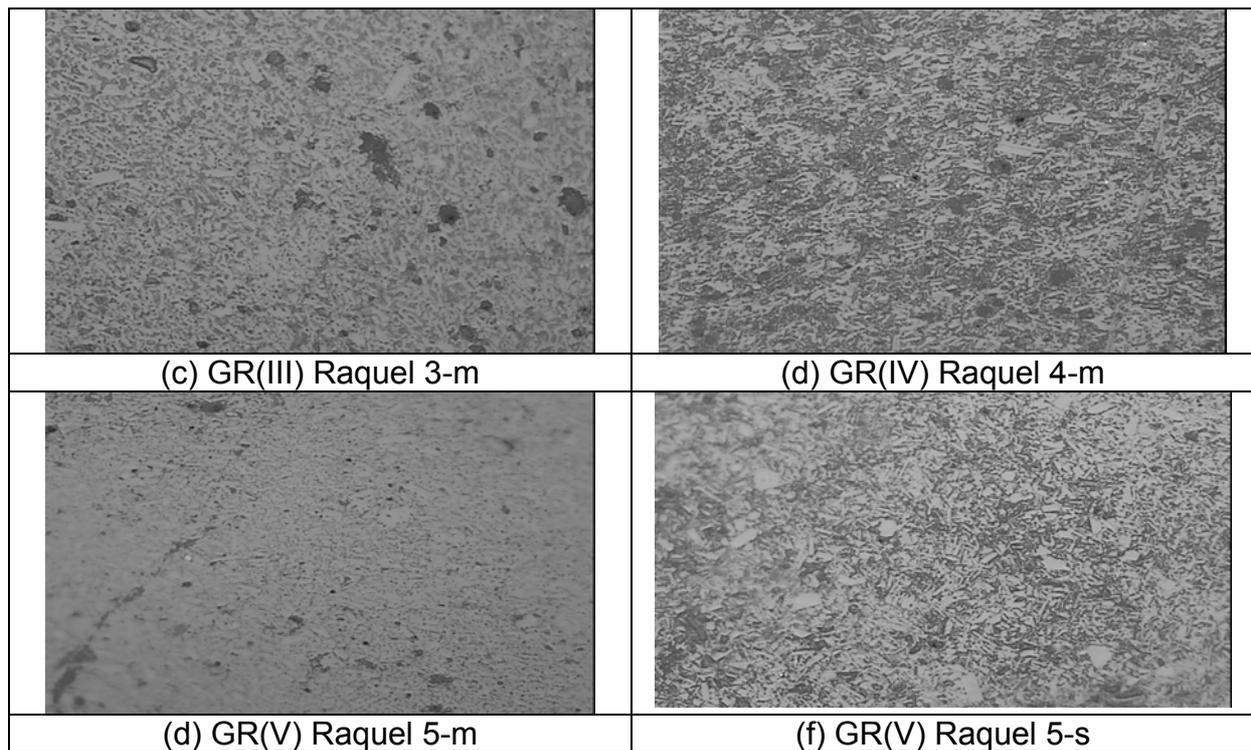
**Figura 2.** Micrografias óticas dos núcleos das seções de fratura (lixadas e polidas) de amostras dos Grupos I a V. (m = meio ou núcleo, s = borda sul).
