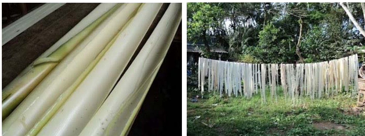
Figura 3. Lâminas do caule da bananeira e fibras de bananeira dispostas para secagem.
