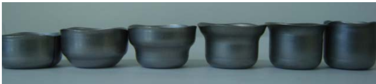
Figura 6: Estágios da operação de reembutimento do aço A.
