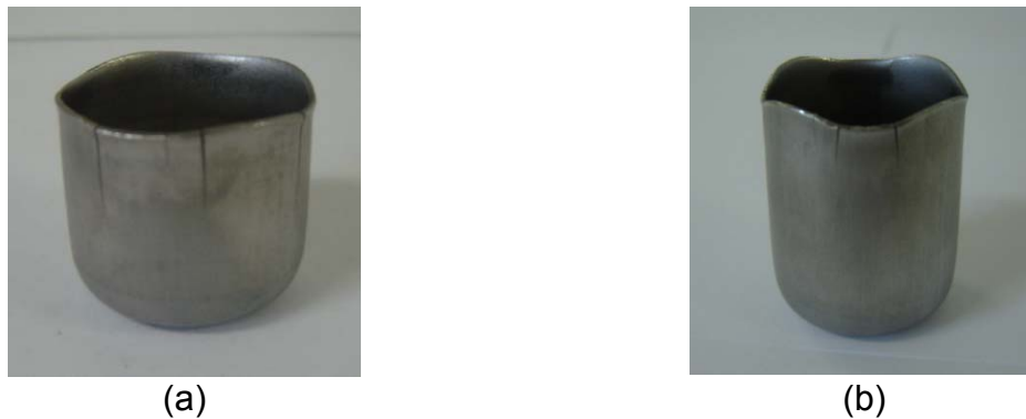
Figura 2. Fenômeno de Delayed Cracking nos aços A e H para as razões limite do embutimento LDR-DC=2,15 e 2,42, respectivamente.
