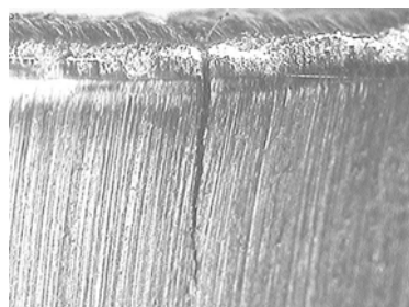
Figura 3: Vista em detalhe de uma das trincas abertas na borda do copo reembutido do aço H. Ampliação: 9x.
