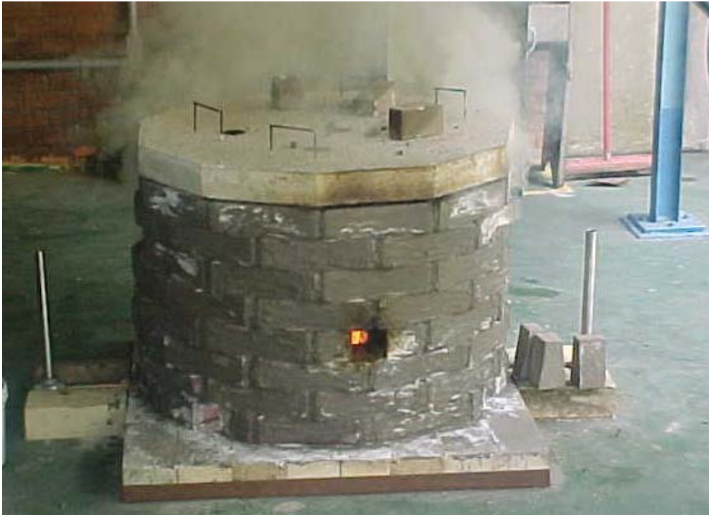
Figura 2 – Forno de carbonização no estágio inicial de aquecimento.
