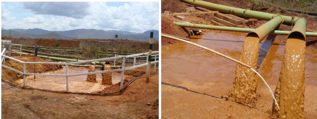
**Figura 5.** Descarga da água bombeada no pré-sump e adição da cal.
