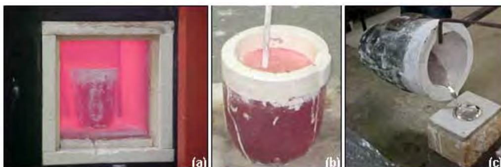
Figura 1. Esquema de preparação e obtenção das ligas fundidas: (a) fundição do material; (b) injeção de argônio; (c) coleta de amostras para análise química.
