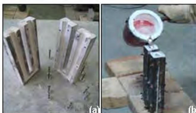
Figura 2. Lingoteira em forma de “U”: (a) desmontada; (b) no momento do vazamento.
