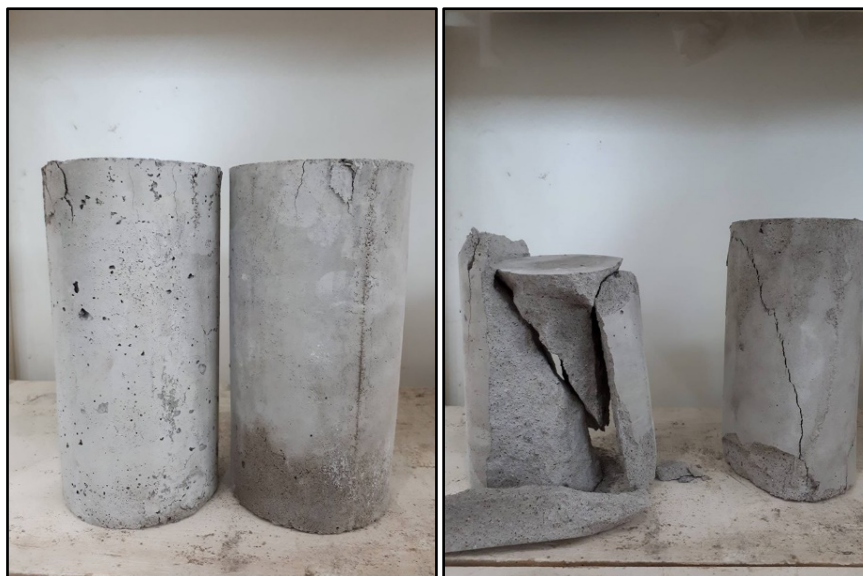
Figura 5 – Corpos de prova dos concretos convencionais e leves após ruptura
