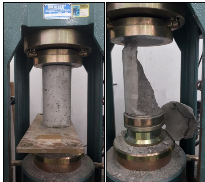
Figura 3 - Prensa hidráulica SOLOTEST® durante a realização do ensaio de resistência à compressão e ruptura dos corpos de prova.
