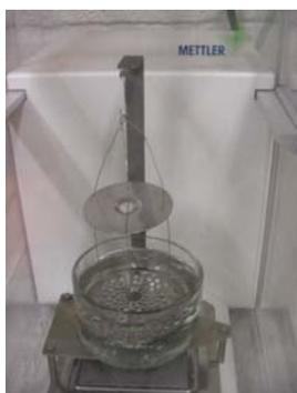
**Figura 2** - Bandeja dupla utilizada para a medição da massa específica e porosidade aberta das amostras
