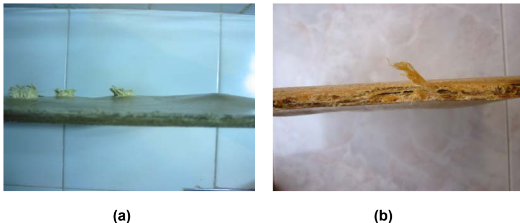
Figura 4. Vista das placas após ensaio balístico: (a) como recebido; (b) irradiada com 250 kGy; observa-se a delaminação resultante dos impactos
