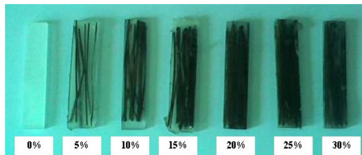
Figura 1. Corpos de prova de compósitos de fibra de piaçava com diferentes frações volumétricas, reforçando matriz epóxi, para ensaios de DMA.
