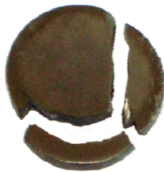
Figura 3. Amostra de M2 com nitretação gasosa quebrada.
