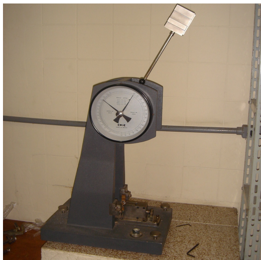
Figura 2. Ilustração do pêndulo de impacto com martelo Izod em posição para romper um corpo de prova.
