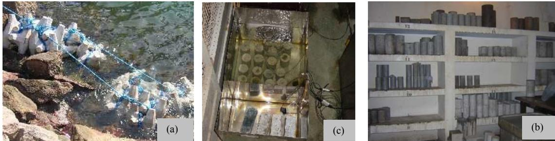
**Figura 2** – (a) Blocos em ambiente marinho; (b) corpos-de-prova em tanque simulando o ambiente marinho; (c) Corpos-de-prova na câmara úmida.
