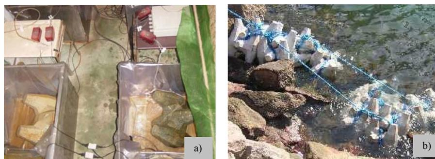
**Figura 3** – a) Blocos em tanques simulando o ambiente marinho; b) blocos em ambiente marinho.
