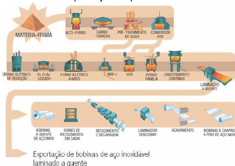
Figura 1. Fluxo de produção de bobinas e chapas de aço inoxidável da Aperam Timóteo.
