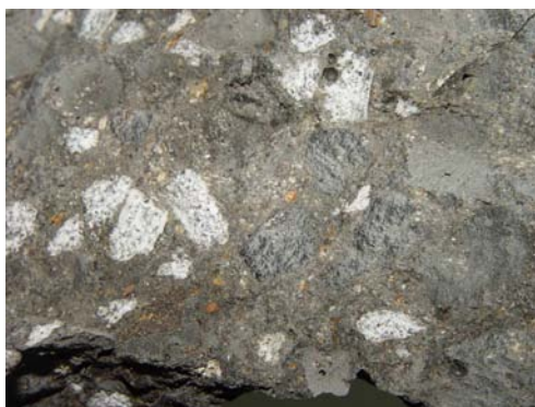
Figura 6. Macroestrutura do concreto rompido aos 29 dias. Traço de substituição de 50% de resíduo sólido casca cerâmica.
