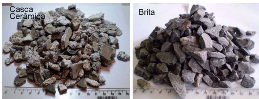
Figura 3. Comparação entre o material cerâmico e a brita utilizada no trabalho.
