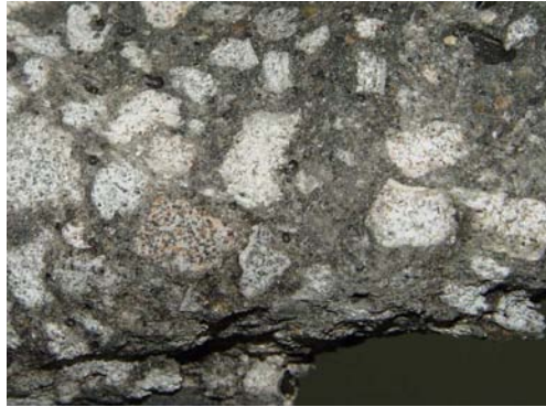
Figura 7. Macroestrutura do concreto rompido aos 29 dias. Traço de substituição de 100% de resíduo sólido casca cerâmica.
