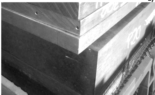
Figura 1: a) Tratamento das peças no formato de “sanduíche”: blocos de aço P20 colocado sobre as peças dos aços ferramenta em estudo. b) Detalhe dos furos e da colocação dos termopares. Ainda não publicado.
