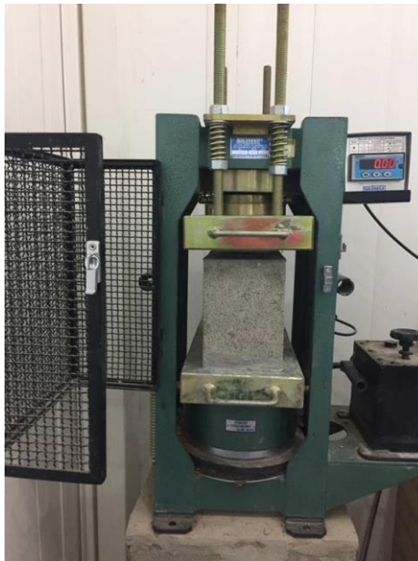
Figura 2. Prensa hidráulica SOLOTEST® durante a realização do ensaio de resistência à compressão dos blocos de concreto.
