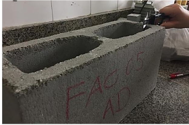
Figura 1. Análise da espessura do bloco de concreto.
