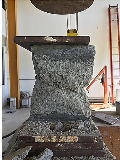
Figura 3. Modo de ruptura dos blocos de concreto à compressão.
