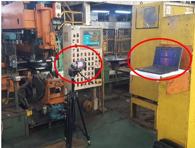
**Figura 3.** Equipamentos de captação da imagem térmica dos cordões de solda.
