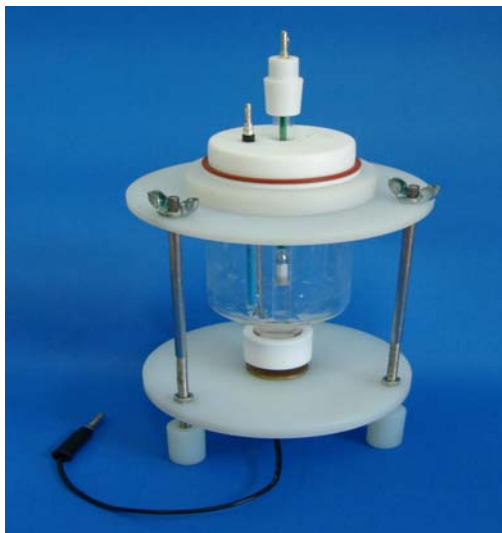
Figura 3. Célula eletroquímica utilizada nos ensaios de corrosão.
