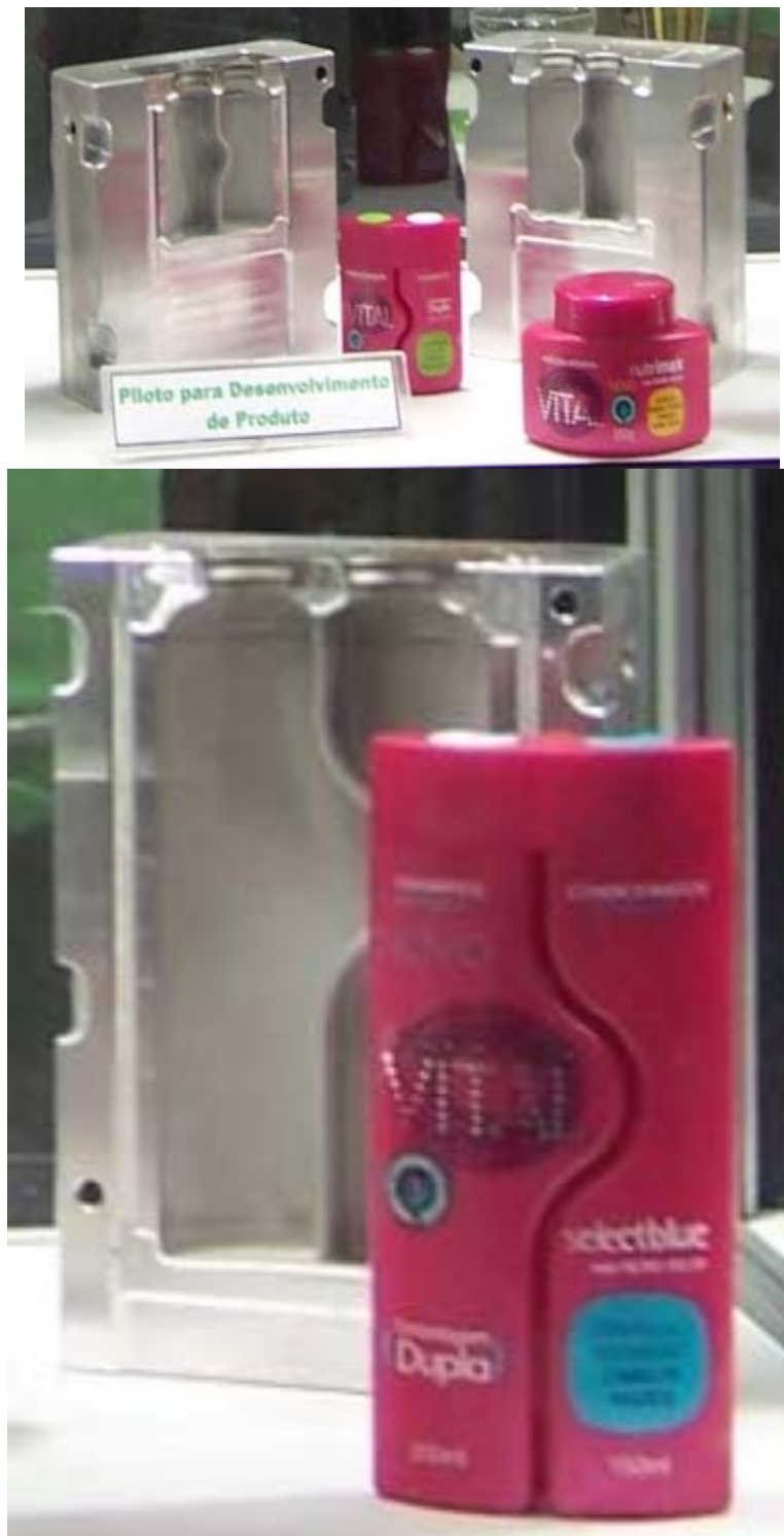
Figura 10. Fotografia dos dois moldes piloto e seus respectivos produtos.
