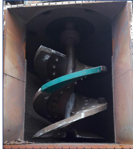
Figura 4. Revestimento helicoidal novo.
